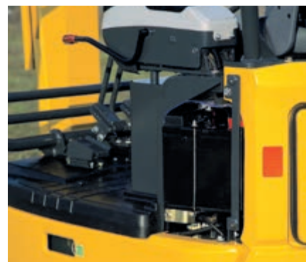
Cofano sinistro: accesso alla batteria
