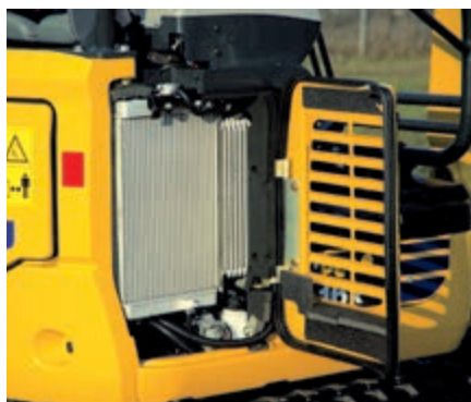
Cofano destro: ispezione e pulizia dei radiatori
