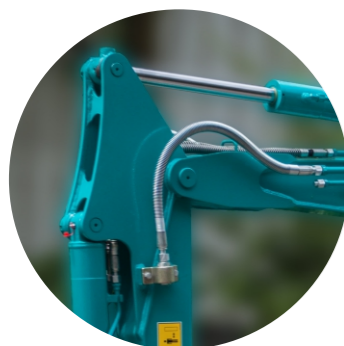
Protezione dei tubi in acciaio
